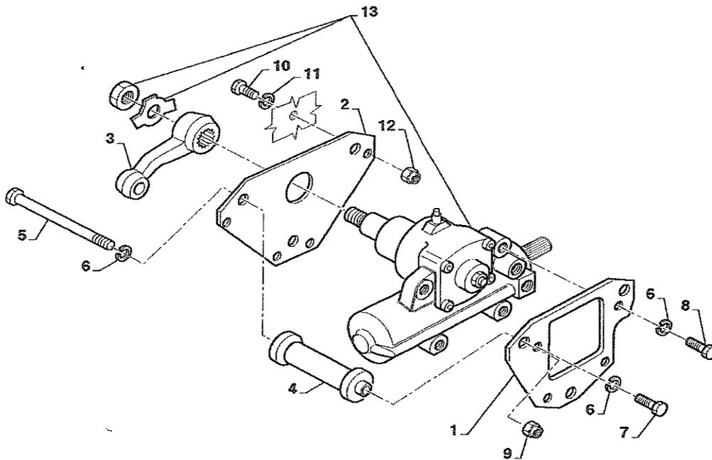
**BREMACH**Idroguida /servoattuatore idraulico
